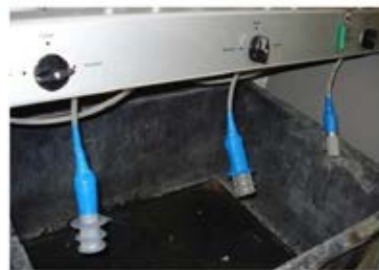
Fig. 1-2-3 Sistema utilizzato per la prova di tenuta
