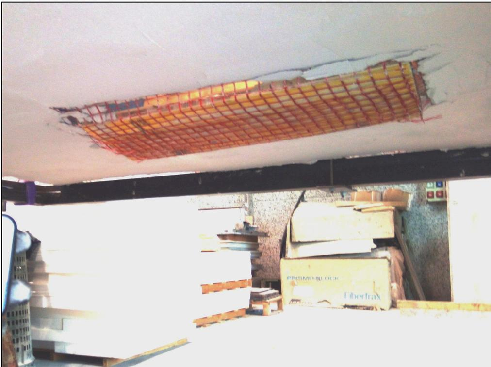
**Fotografie della rottura della rete dopo la prova sul sistema "S6"**
