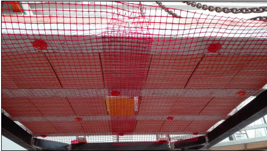
Fotografia della disposizione dei fissaggi per le prove n. 2 e n. 3
