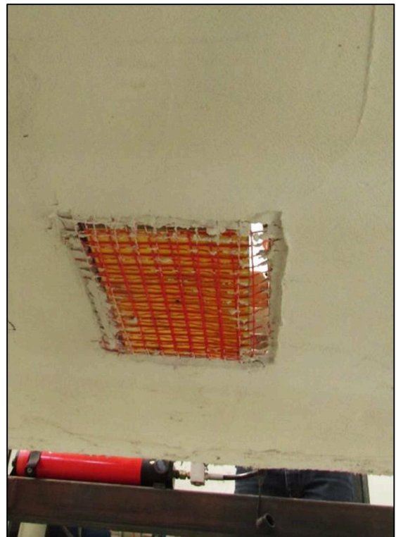
Fotografie della modalità di applicazione del carico nella prova n. 3
