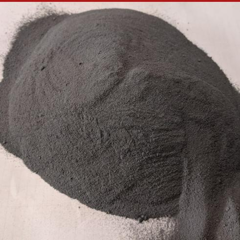
Microsilicati selezionati (silica-fume) di colore grigio per il confezionamento di conglomerati ad elevata densità e prestazioni (impermeabilità, stabilità chimica, resistenza meccanica ecc.), per il confezionamento di malte, intonaci, betoncini e calcestruzzi solfato-resistenti, antidilavanti.
