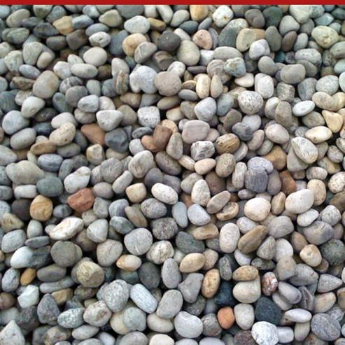
Ghiaietto siliceo, lavato, ciclonato, vagliato, essiccato, selezionato, nella granulometria compresa tra 6 e 10 mm, specifico per l'addizione a malte e intonaci premiscelati strutturali, sia colabili che tixotropici, al fine di migliorare o correggere la curva granulometrica, in base all'aumento dello spessore di getto richiesto.
